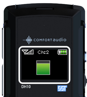
Affichage lors de l'utilisation avec la boucle magnétique
